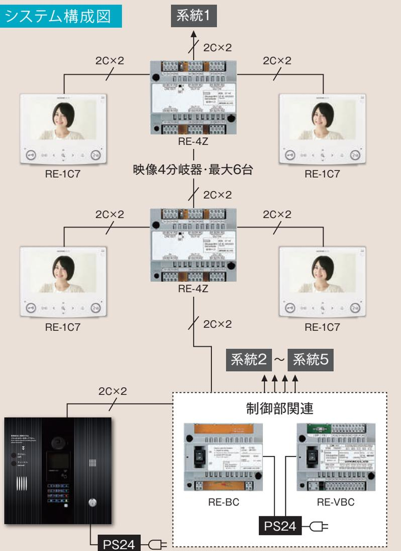
最大接続台数 ●集合玄関機:5台(1系統3台まで) ●居室親機:48台(1系統25台まで) ●管理室親機:2台
